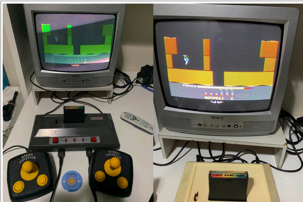
Console Vanevision e seu sinal de vídeo em N-Linha (à esquerda). Funciona com cores adulteradas devido às diferenças entre os sistemas PAL e NTSC. À direita, o mesmo cartucho no console Dynacom. (Foto: Marcelo Sávio)
